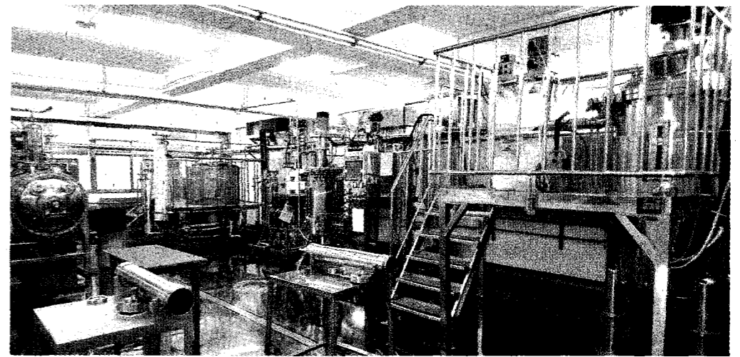
●南臺科大生技中心固態與液態噸級發酵製程試量產線。圖／南臺科大提供
